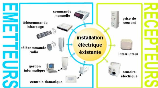
Les modules émetteurs transmettent les signaux de commandes à une fréquence de 120 KHz sous une tension de 2.5V sur les mêmes câbles que le courant 230V.- 50 Hz. Pour éviter toutes confusions avec d'éventuels parasites, le signal est transmis 3 fois de suite à 3.33 milli-secondes d'intervalle.
